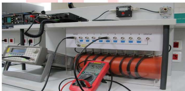
Obrázek 31 Nové rozložení měření napětí podél vedení
