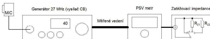
Obrázek 19 - Blokové schéma pro měření PSV
